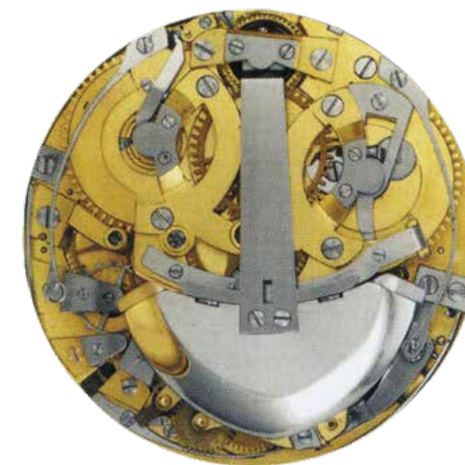
Movement of a pocket watch with pedometer winding and platinum oscillating weight, Charles Oudin, Paris, 1806 ◦ Werk einer Taschenuhr mit Pedometer-Aufzug und Platin-Schwungmasse, Charles Oudin, Paris, 1806
